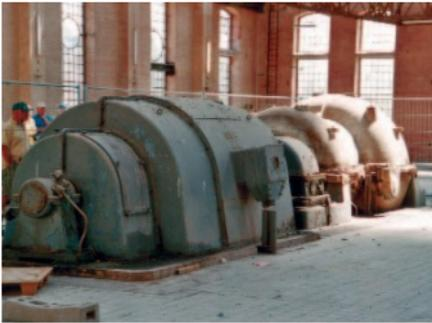
Der Wind für die Hochofen wurde durch die Hochofenwindgebläse, sog. Axial-Turbo-Verdichter, erzeugt. Anfangs erfolgte dies mit 200 t schweren Gaskolbenmaschinen. Fünf dieser Maschinen erzeugten in der Gebläsehalle die erforderliche Windmenge bis zum Jahre 1964.
